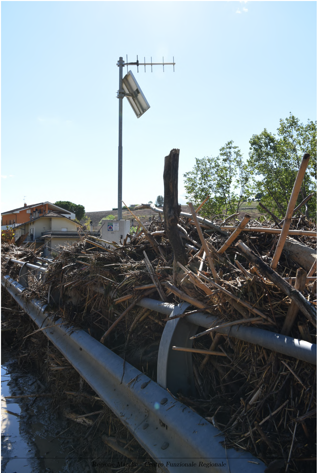
Figura 44: Idrometro di Pianello di Ostra, sul fiume Misa, reso inutilizzabile dalla piena del 15 settembre.
